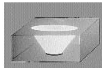
Мал. 2. Оптичний ефект проходження світла з води до повітря. Коефіцієнт заломлення світла: вода — 1,33; повітря — 1,00
